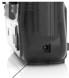
Ladebuchse für wiederaufladbare Akkus Charging plug for rechargeable transmitter batteries
