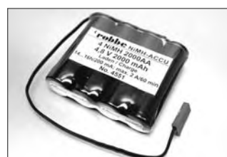
Power Pack No. 4551 4 NiMH 2000AA Flach Hochkapazitäts NiMH-Akku. 4,8 V, 2000 mAh. Gew. 115 g Abmess.: 51 x 57 x 14,5 mm Ladestrom max.: 2 A
